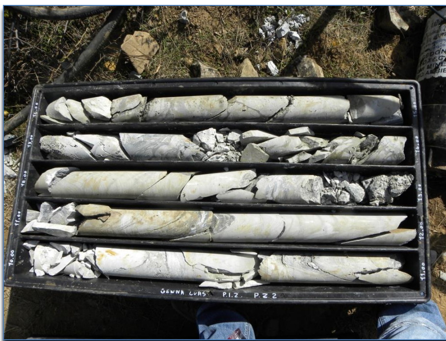
Foto 2 – Fratturazione delle rocce attraversate con sondaggio PZ2ND alla progressiva compresa tra 11,00 e 16,00 m da p.c.
